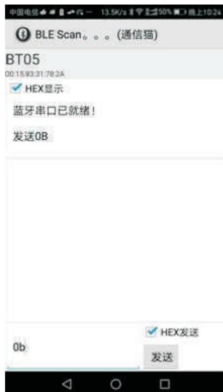
给测距仪通电后，先打开手机蓝牙功能（一定要先打开手机蓝牙功能在启动APP软件），在启动“BLE蓝牙串口”APP，等待连接，连接成功后显示下图：
