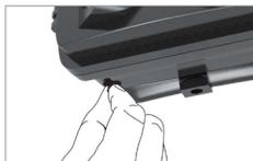
2.将电源线连接到摄像机侧面的位置,该侧面在摄像机门的铰链后面有一个挂钩。这将支撑电源线并减轻连接点的压力。
