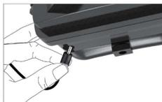
3.不用时,请装回摄像机底部的橡胶端口盖,以保护6V DC通用插入端口。
